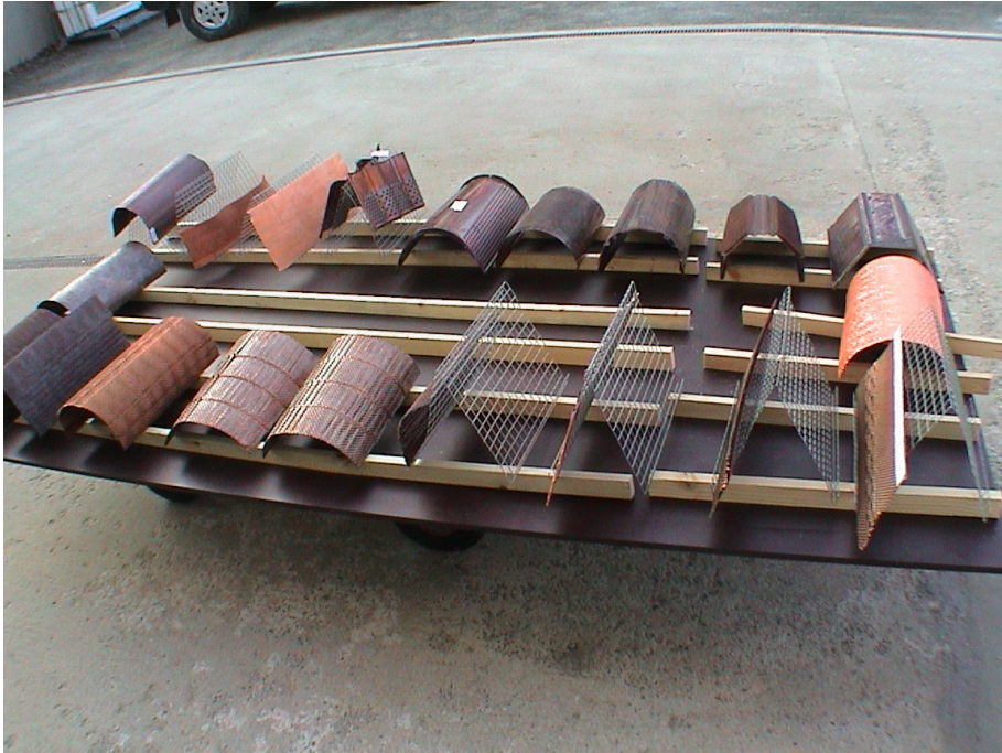
Bild 3: zu untersuchende First-Elemente aus Kupfer
