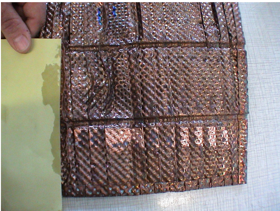
Bild 6: Feuchtigkeit in den Ionen-Produktions-Falten
